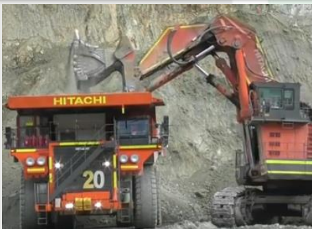
Carguío de Pala - Camión
