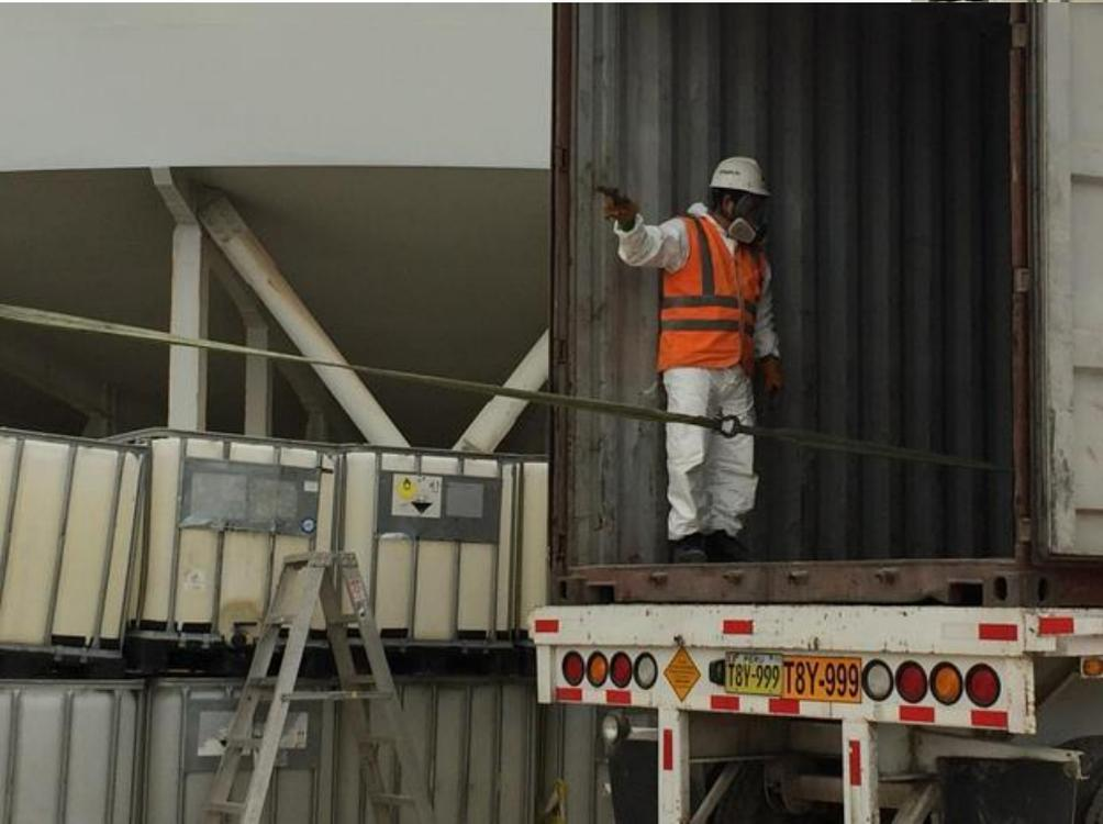
Posible caída de la plataforma por un mal cálculo del operador del montacarga. Se indica también el punto donde se sujeta la eslinga.'
